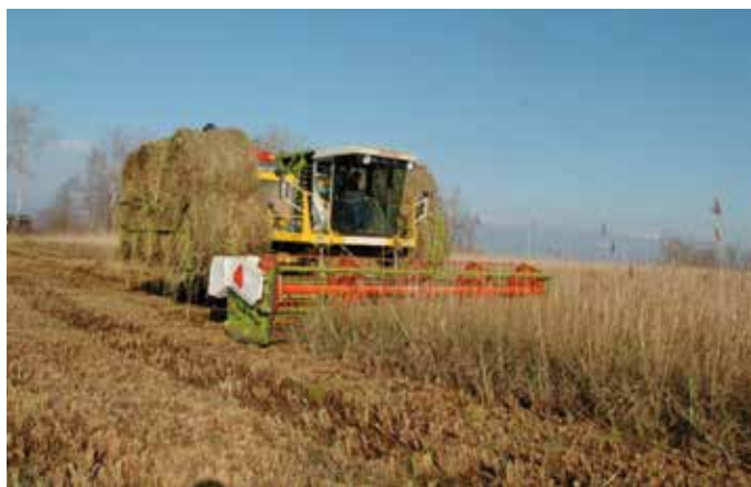
Figure 4 : La faucheuse Elbotel dispose d'un train de chenilles larges (1m20), permettant d'exercer une pression faible au sol (moins de 300 g/cm 2 ). Elle est équipée d'un peigne de coupe de 6 m de largeur, d'une presse à balles, et de passerelles latérales permettant de stocker 22 balles de paille d'un poids moyen de 300 kg. A plein, le poids total de la machine est de près de 30 t. La machine présentée sur la photo est la 3 e évolution de Elbotel, depuis sa création en 1984. Photo : collection Grande Cariçaie.
